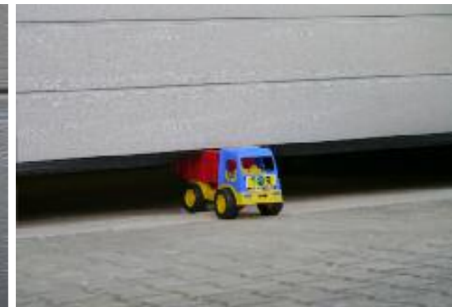
Der erste Plastik-LKW wurde durch das Auftreffen des alten Tores mit rund 80 Kilo (800 Newton) zerstört. Das neu eingebaute Sectionaltor berührte den LKW mit zulässigen 40 Kilo (400 Newton), beschädigte ihn nicht und fuhr nach Auftreffen automatisch hoch.
